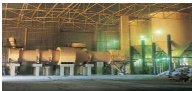
Figura 17 – Secador de açúcar de tambor rotativo
