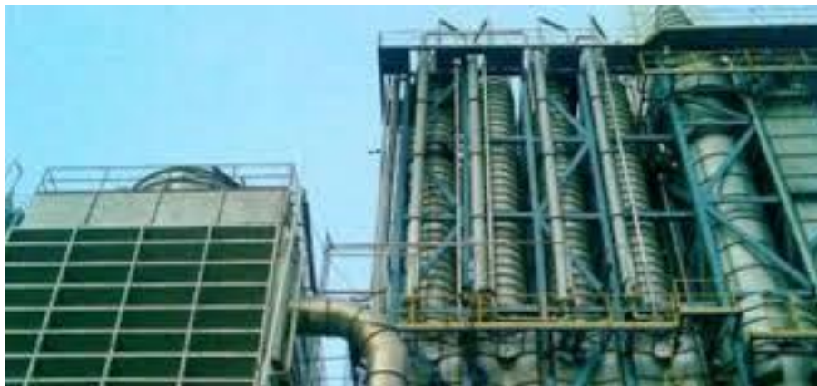
Figura 12 – Modelo de Evaporador tipo Névoa Turbulenta
