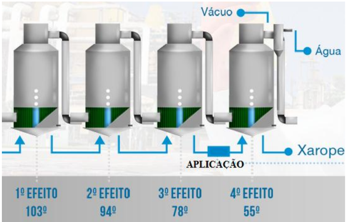
Figura 20 – Esquema de dosagem no Pré Xarope
