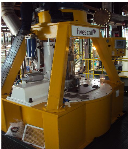
Figura 16 – Centrífuga de Açúcar (Por Batelada)
