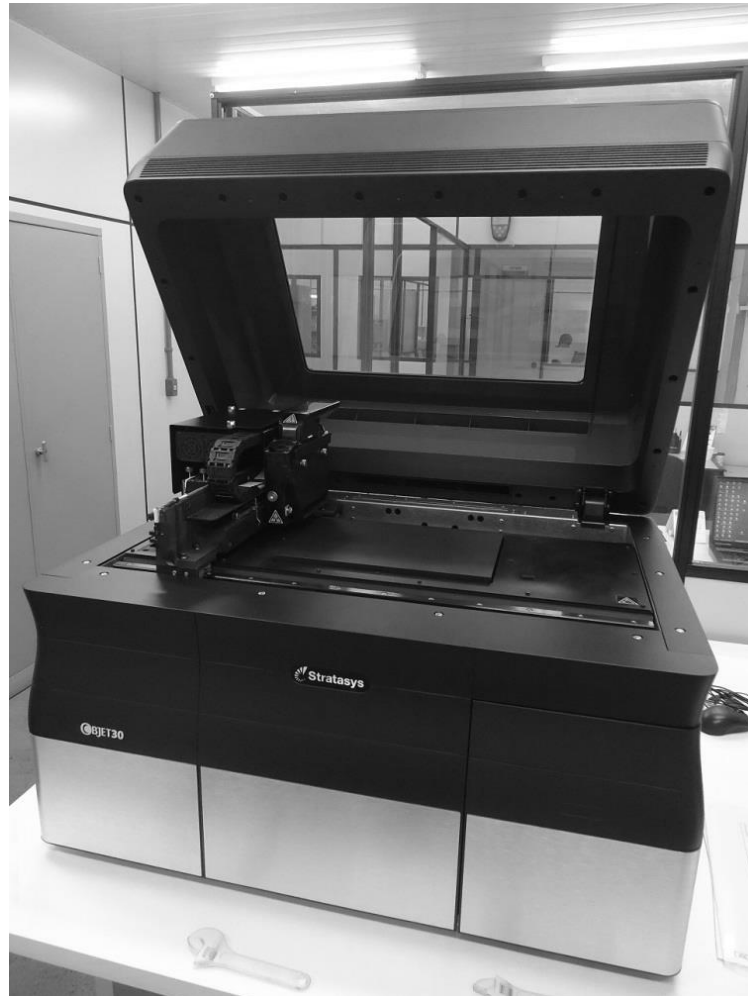
Figura 31 - Equipamento de impressão a jato de tinta (IJP) da Polyjet.
