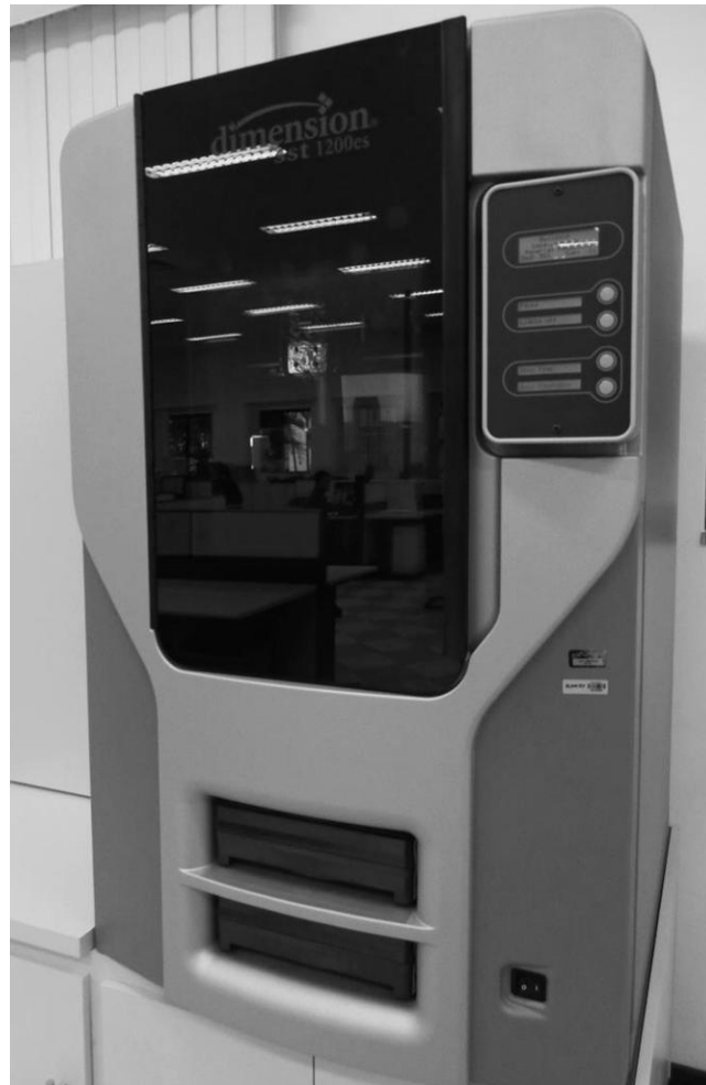
Figura 26 - Equipamento FDM, uma modelação por extrusão de plástico
