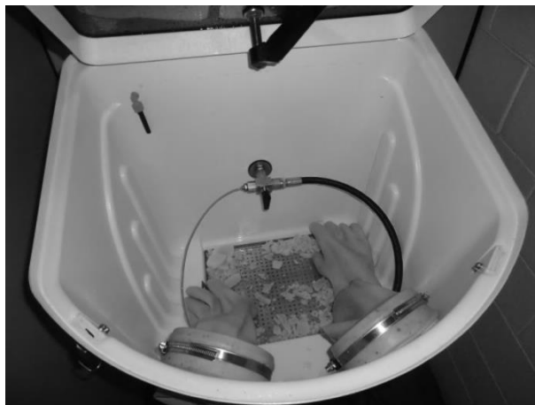
Figura 32 - Lavagem a jato de água em câmara fechada.
