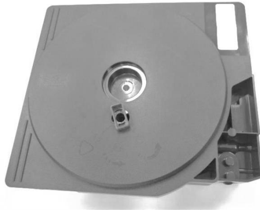
Figura 27 - Cartucho de impressão (Filetes de plásticos ABS plus)
