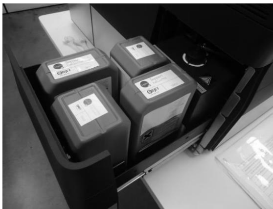
Figura 30 - Reservatório de matéria prima
