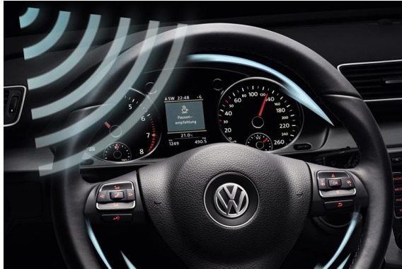
Figura 14: Exemplo de dispositivo para inspeções informativas (Verificador de fadigas)
