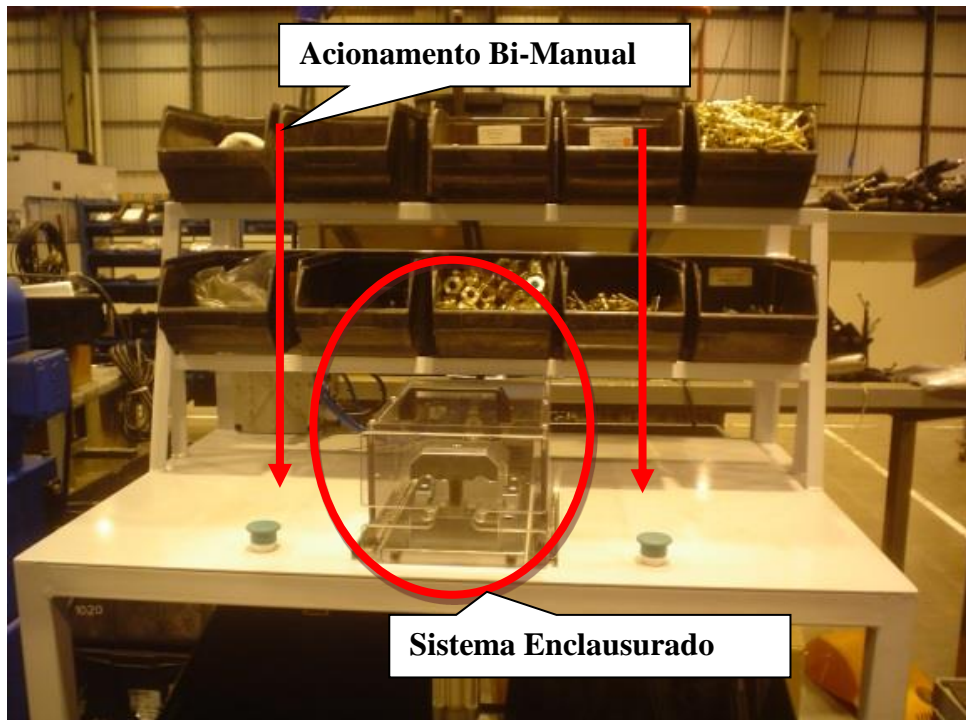
Figura 20 – Detalhes da Bancada Seguindo a Norma NR-12
