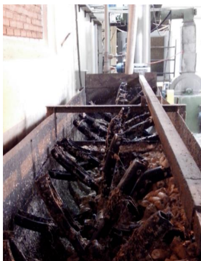
Figura 8 – Lavagem e descascamento
