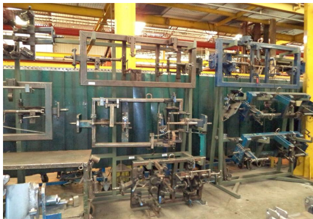
Figura 19: Verticalização dos dispositivos de solda
