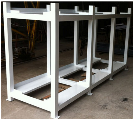
Figura 14: Rack para subconjunto solda
