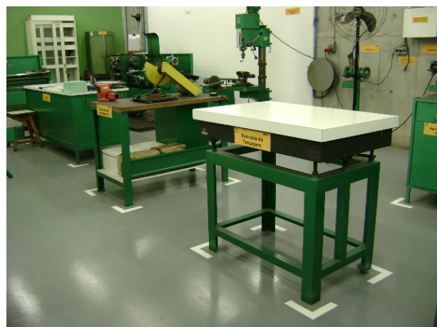
Figura 5: Bancadas com demarcação no solo
