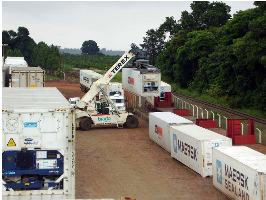
Figura 21 – Contêineres sendo alocados nos vagões ferroviários (Cambé/PR)
