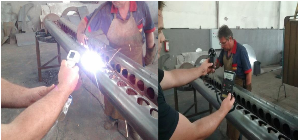
Figura 13 – Utilização do Termômetro infravermelho e Anemômetro no setor de corte
