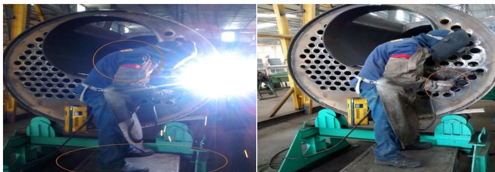
Figura 20 – Postura inadequada da operação de solda.
