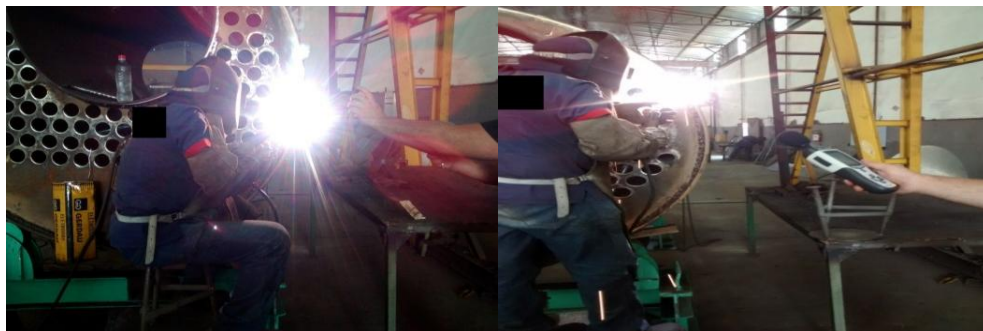
Figura 11 – Utilização do Luxímetro e Decibelímetro no setor de soldagem
