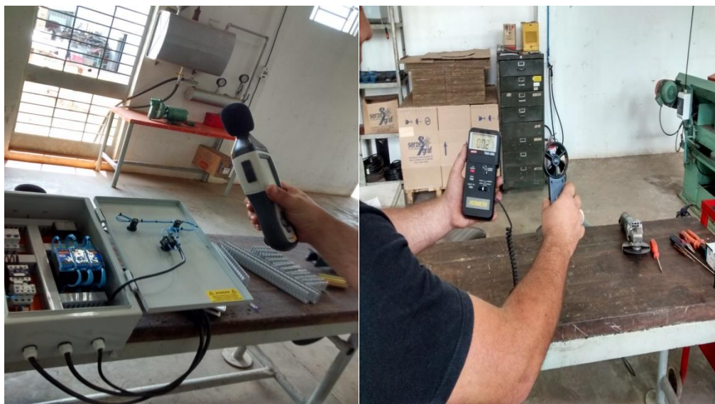
Figura 16 – Utilização do decibelímetro e anemômetro no setor elétrico
