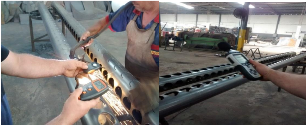
Figura 12 - Utilização do Luxímetro e Decibelímetro no setor de corte
