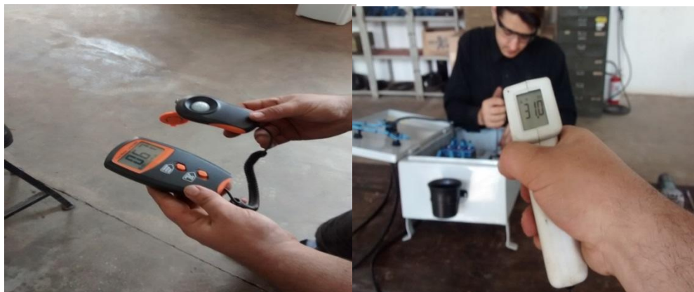
Figura 15 - Utilização do luxímetro e termômetro infravermelho no setor elétrico
