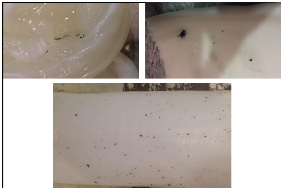
Figura 20 – Impurezas Encontradas 2º Teste
