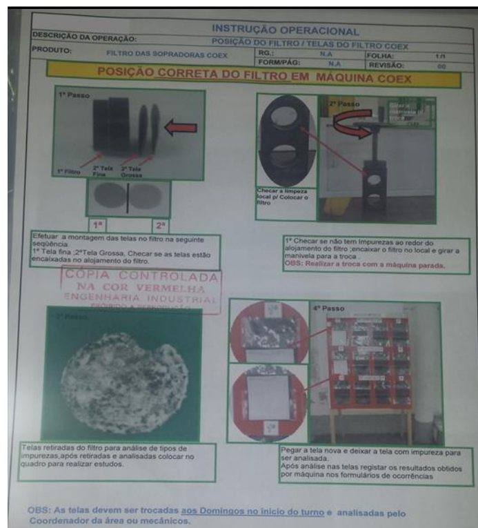
Figura 25 – Instrução Operacional de Troca das Telas.
