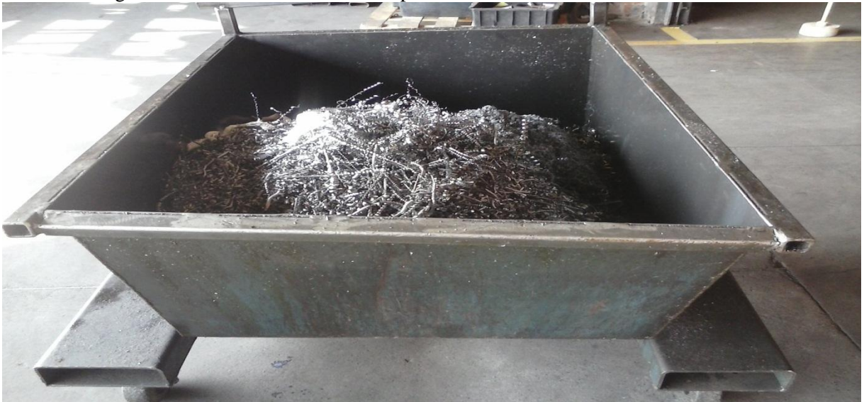
Figura 21: Carrinho onde faz o transporte dos residuos , Ferro e cavaco de ferro.
