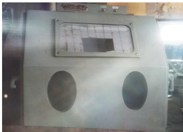
Figura 7 – Cabine de jato de areia
