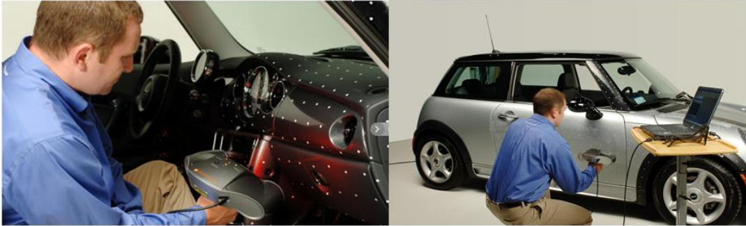
Figura 15 - Digitalização sem contato físico
