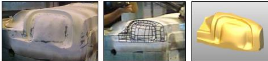
Figura 4 - ER aplicada à reprodução de um modelo existente.
