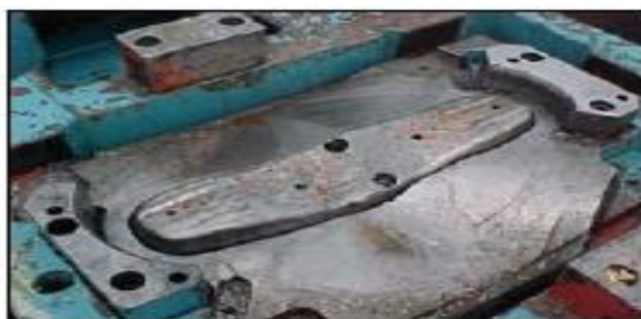
Figura 5 - ER aplicada à correção de um modelo danificado.
