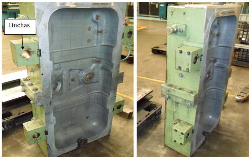
Figura 22 - Cavidade do molde a ser alterada.
