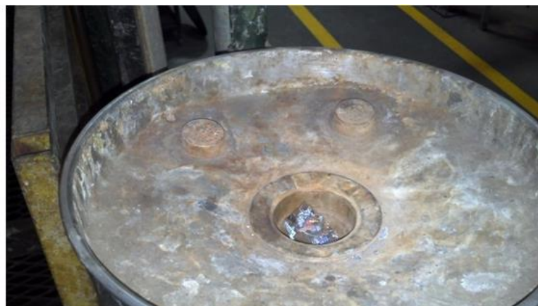
Figura 13 - Filtros sujos, impróprios ao uso.
