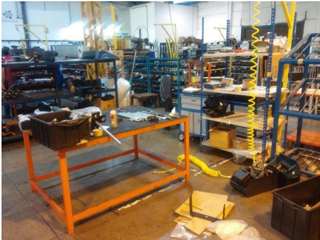
Figura 9 – Bancadas e locais de trabalho sem organização.
