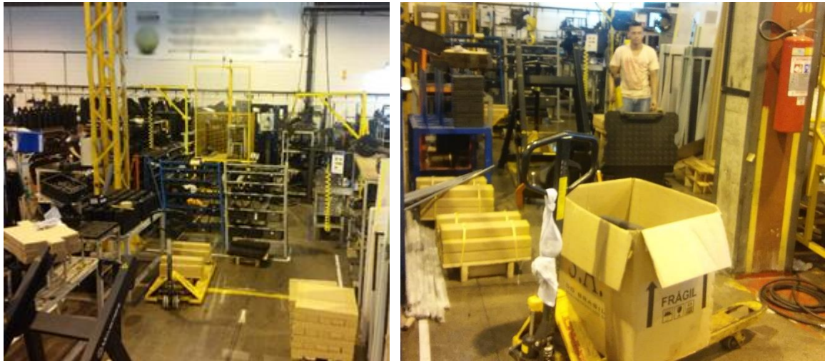
Figura 16 - Sub montagem sem definição de área
