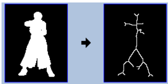
Figura 18 – Exemplo do tratamento Thinning realizado com o Morphology.
