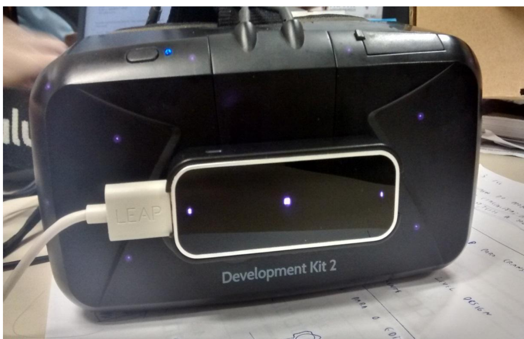
Figura 29 – Dispositivo Leap Motion acoplado ao Óculus Rift
