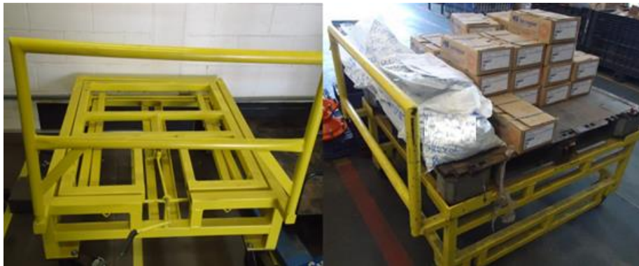
Figura 11 – Rack para elevação de caixa móbil
