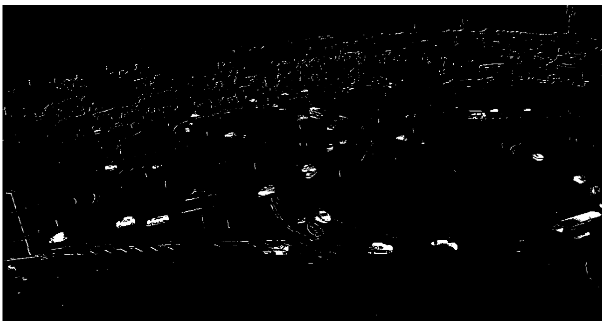
Figura 4.6 – Imagem binária de representação de um frame com aplicação do método MOG de subtração de fundo. (Autoria própria)
