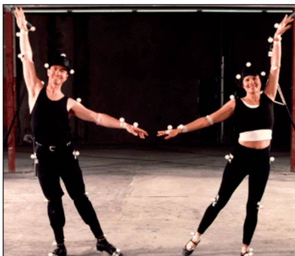
Figura 23 – Roupa com marcadores passivos (SILVA, 2002)
