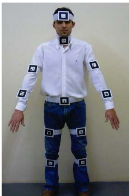
Figura 22 – Posicionamento dos marcadores no corpo humano (SEMENTILLE et al., 2004)
