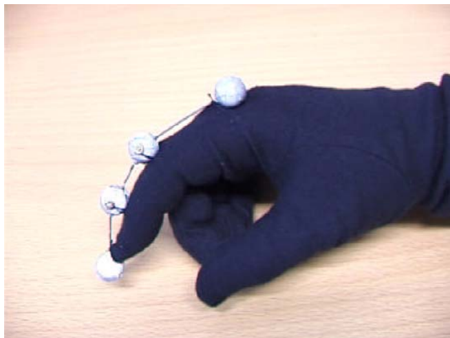
Figura 36 – Luva com esferas retroreflexivas
