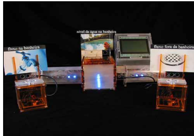
Figura 32 - System Blocks simulando o fluxo da água através de uma banheira (Zuckerman e Resnick, 2004).
