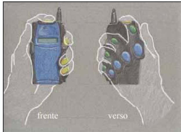
Figura 29 – Esquema do ComTouch com suporte na parte de trás de um celular (Chang et al , 2002).
