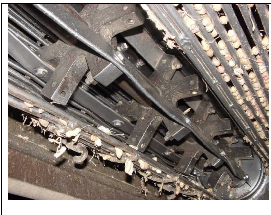
Figura 38: Visão interna de um Descascador.
