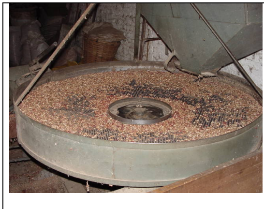
Figura 40: Parte da máquina de limpeza, onde impurezas são extraídas do amendoim.
