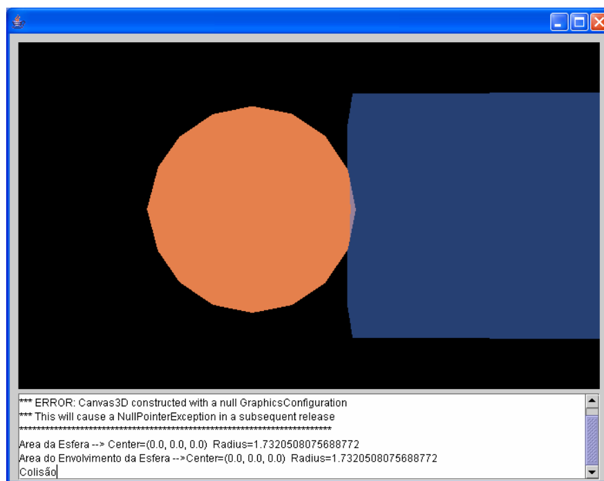
Figura 22 – Demonstração da detecção de colisão por faces com primitivas simples.
