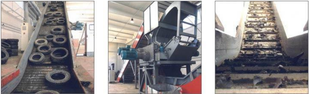
Figura 9 - Triturando o pneu para reduzir o seu volume
