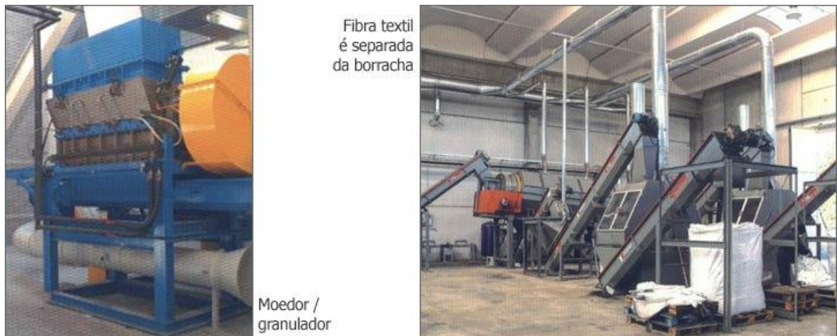
Figura 12 - Limpeza da borracha
