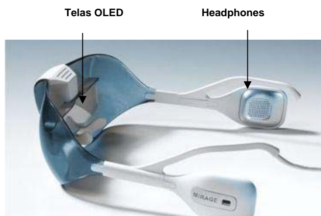
Figura 11 – Representação de HMD OLED com duas telas e dois headphones (Vrealities, 2007)
