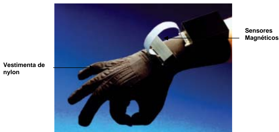
Figura 14 – 5DTGlove com sensores magnéticos, onde o receptor detecta a intensidade do sinal sob os três eixos, caracterizando o movimento (Dayeang, 2007)
