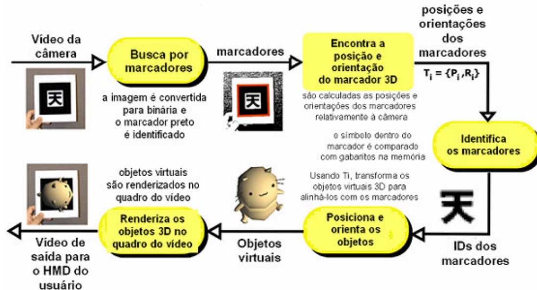
Figura 1 – Representação do processo de reconhecimento dos marcadores e o posicionamento de modelos virtuais (traduzido de Kato et al, 2000).
