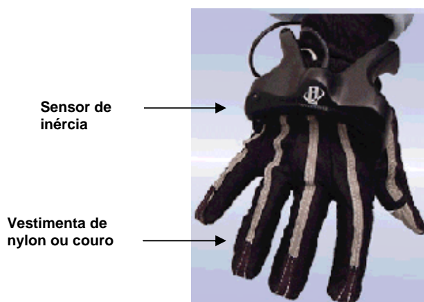
Figura 18 - Representação de uma CyberGlove com sensores inerciais, os quais registram os deslocamentos a partir de uma posição de origem definida pelo sistema (Immersion, 2007).
