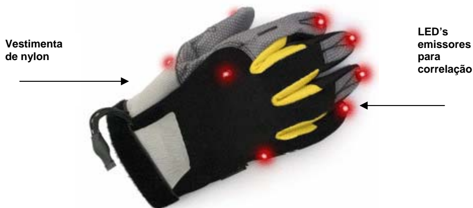
Figura 15 – Impulse Glove com rastreamento óptico, que determina a posição por correlação de posições sob diversos emissores LED's (PhaseSpace, 2008)
