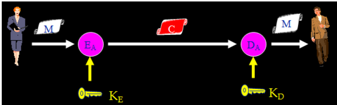
Figura 4 - Ilustração do processo de cifração/decifração com chave assimétrica
