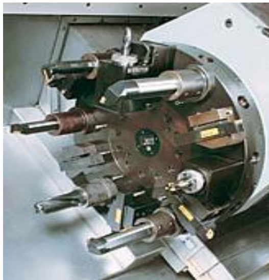
Figura 16 - Torre Porta Ferramentas com 12 posições - Ergomat
