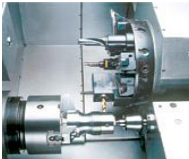
Figura 15 - Torno CNC com ferramenta acionada
