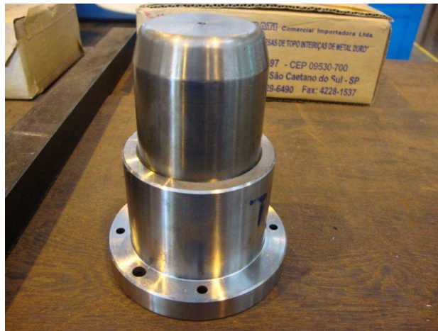
Figura 23 - Montagem entre Coluna/Bucha dos moldes
