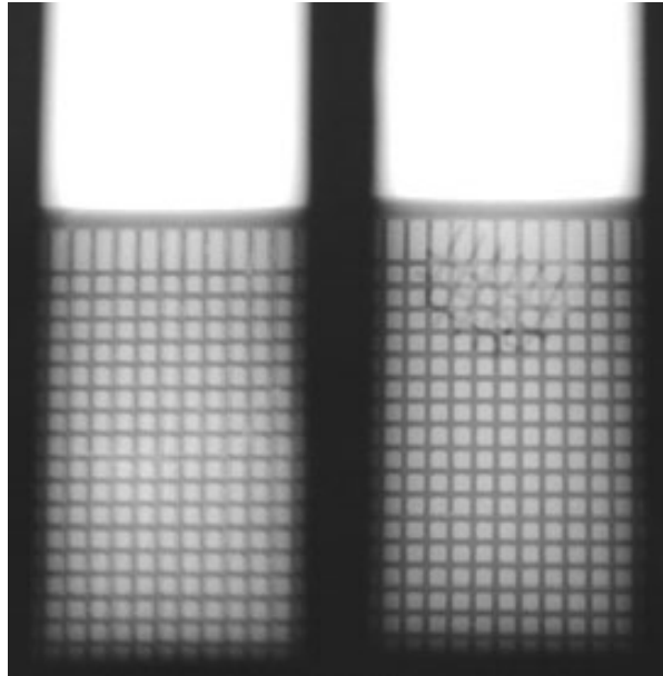
Figura 11 – Radiografia de um defeito de fundição: Inclusões.
