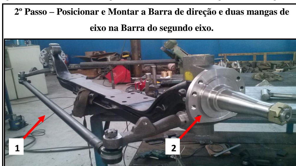
Figura 19 - Passo 2 da Montagem do 2º eixo dianteiro dirigível Ford Cargo 2429.
