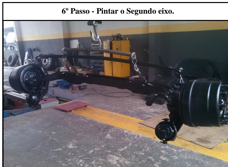
Figura 23 – 6º Passo da Montagem do 2º eixo dianteiro dirigível FORD Cargo 2429.
