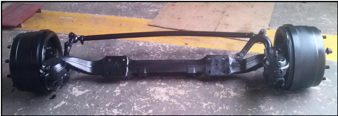
Figura 24 - Segundo eixo dianteiro dirigível FORD Cargo 2429 montado.
