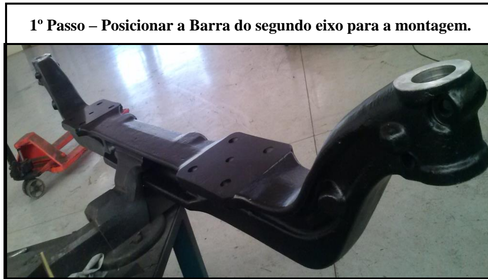
Figura 18 - 1º Passo da montagem do 2º eixo dianteiro dirigível Ford Cargo 2429.
