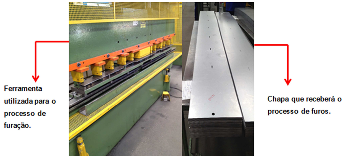
Figura 12 – Processo de furação das peças verticais no setor de dobradeira.
