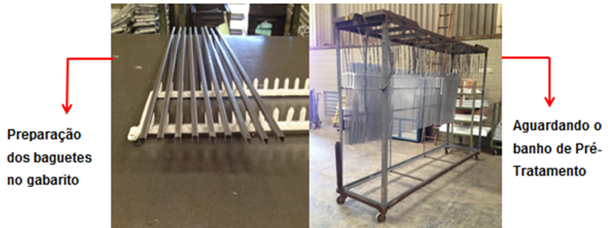
Figura 17 – Preparação dos baguetes para o tratamento de superfície.
