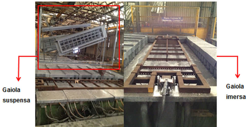
Figura 19 – Proteção de superfície pelo processo cataforese.
