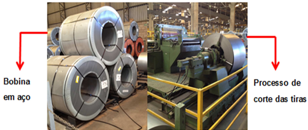
Figura 14 – Processo de Corte de tiras.
