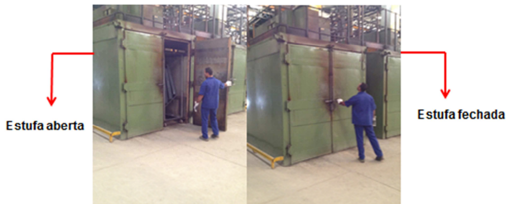
Figura 20 – Secagem da pintura de fundo em estufas.
