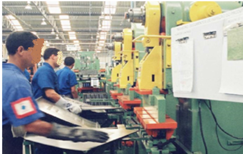
Figura 13 – Furação das peças horizontais no setor de estamparia.
