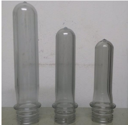
Figura 5 - Pré-formas para embalagens de 2.000 ml (esquerda), 1.000 ml (centro) e 600 ml (direita) utilizadas no processo de sopro de embalagens PET
