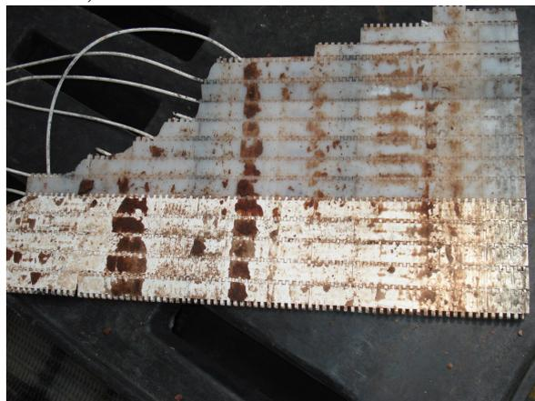
FIGURA 5 – Trecho de esteira de transporte de confeitos danificada. Fonte: o autor.
