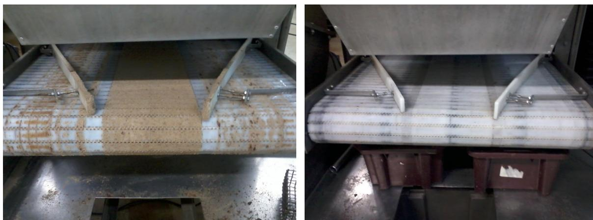
FIGURA 4 – Esteira de transporte dos confeitos antes e após a limpeza. Fonte: o autor.
