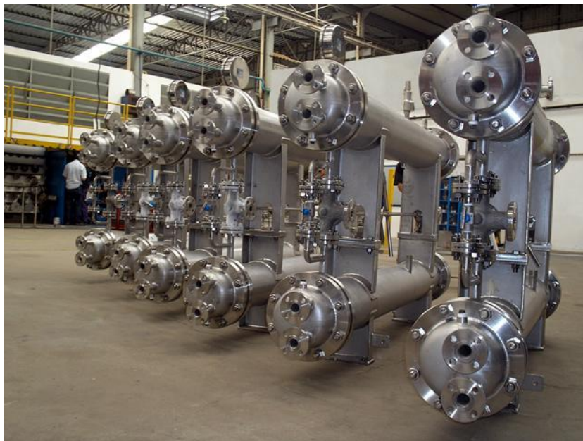
Figura 9 – Trocadores de calor
