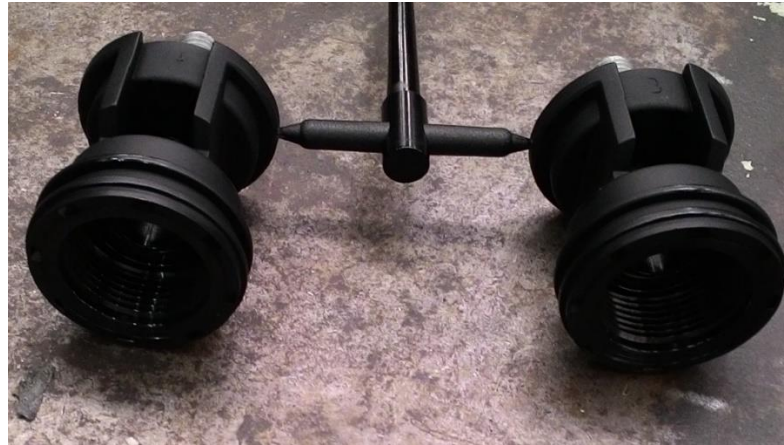
Figura 23: Fixador saindo do processo de injeção
