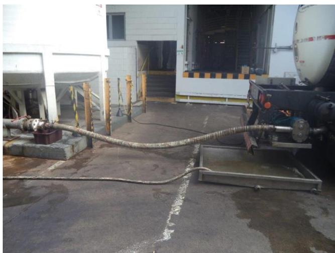
O tempo para que o processo seja concluído é de aproximadamente 3,5 horas. Quase ao término do processo de descarregamento, a carreta é inclinada, utilizando-se de um cavalete pertencente à própria carreta. Isso facilita o escoamento do Xarope.
