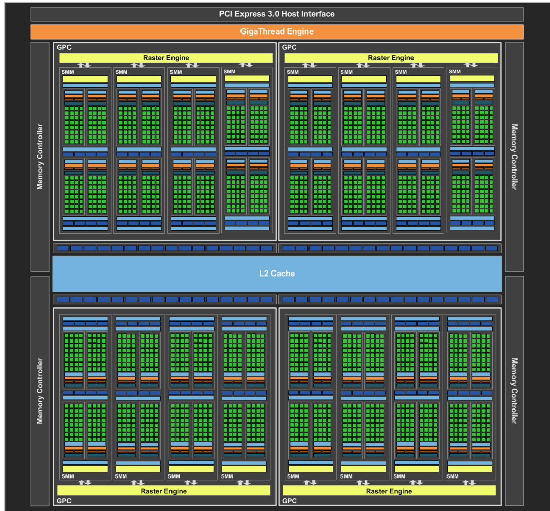
Figura 2.5 - Arquitetura Maxwell – Fonte: SMITH, R.; ANANDTECH, 2014
