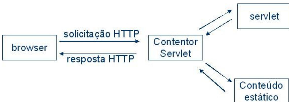
**Figura 2 4 - Esquema de funcionamento do servidor Tomcat**
