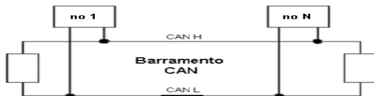
Figura 21 - Forma recomendada de conexão ao barramento
