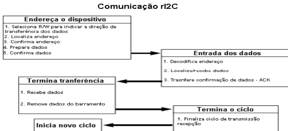
Figura 40: Esquema de Comunicação do Protocolo I2C
