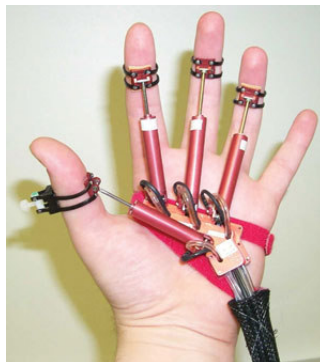
Figura 1.13: Dispositivo Háptico [Diório,2005].
