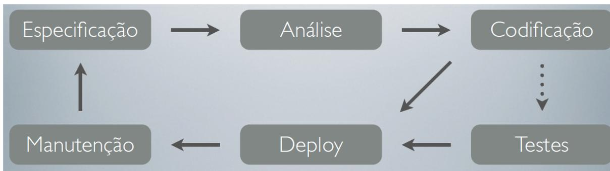
Figura 1 - Fluxo desenvolvimento de software sem TDD (DOHMNS, 2010)
