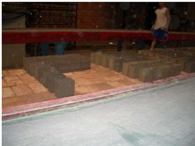
*Figura 12: Peças sendo acomodadas para ir para o Forno.*
