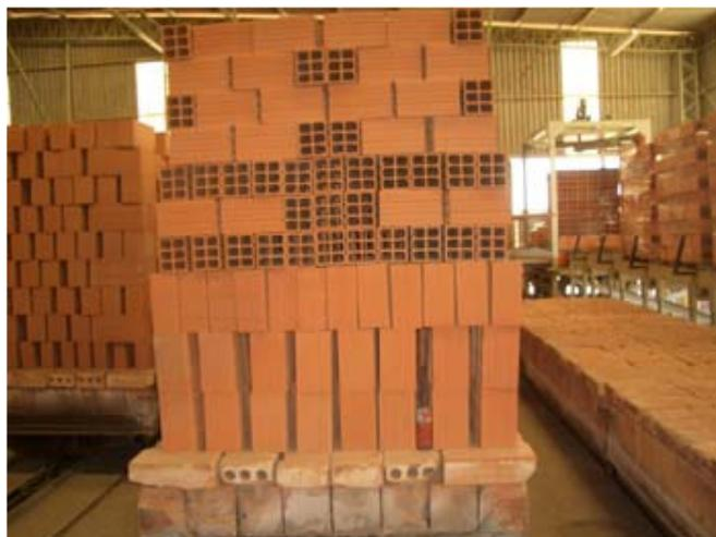
*Figura 15: Peças sendo esfriadas.*
