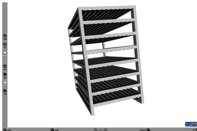
*Figura 6: Suporte; usado para acomodar as peças para ser levado ao secador.*
