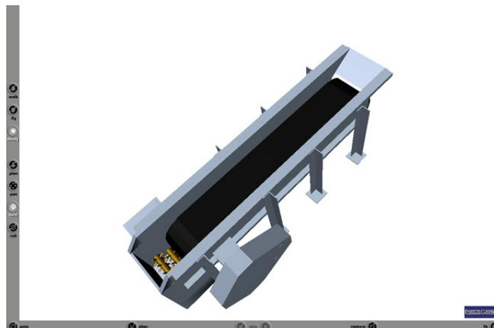
*Figura 9: Dosador Alimentador; tritura partes grandes de argila e dosa a quantidade de argila necessária para o resto da produção.*
