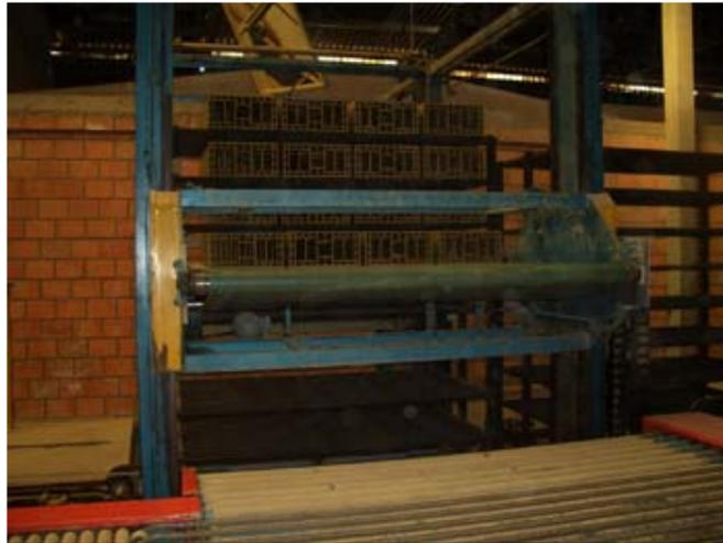
*Figura 8: Peças sendo acomodadas no suporte para ir para o Secador.*
