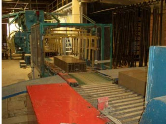
*Figura 7: Cortador Automático.*
