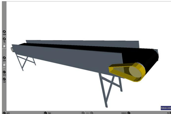
*Figura 5: Esteira; usado para transportar a argila de uma maquina para a outra.*
