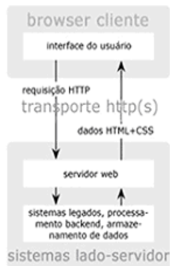
Figura 11 –Modelo de aplicação web clássico. 8
