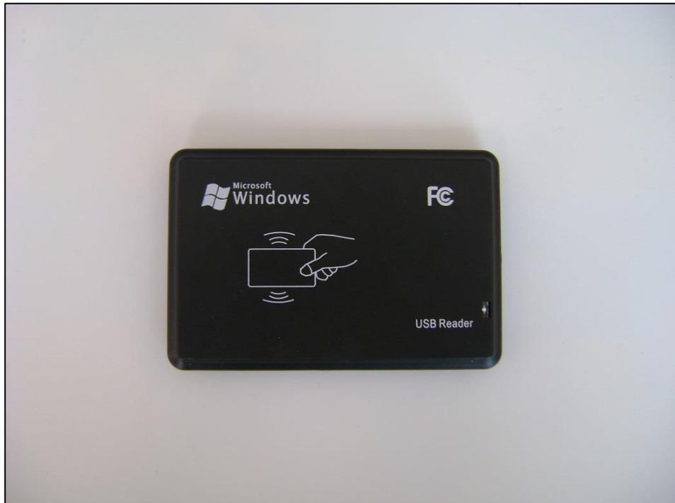
Figura 17. Leitor rfid usb 125khz (Fonte Própria)
