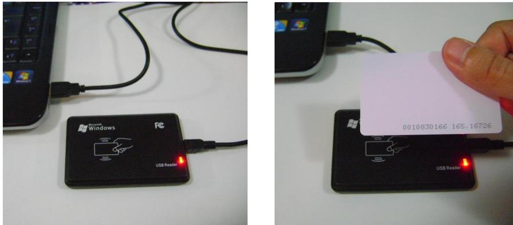
Figura 19. Utilização do leitor RFID (Fonte Própria)
