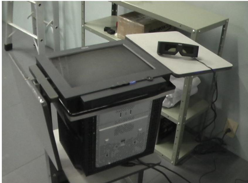
Figura 41 – Protótipo estereoscópico transportável
