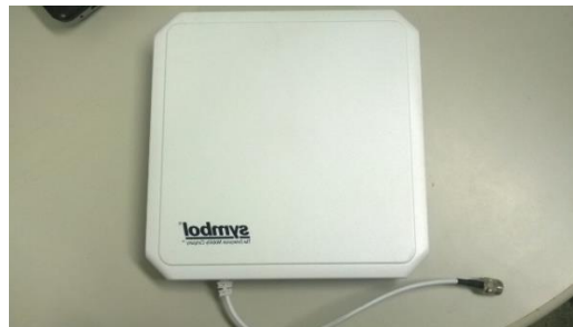
Figura 4. Antena Motorola modelo Symbol AN48.
