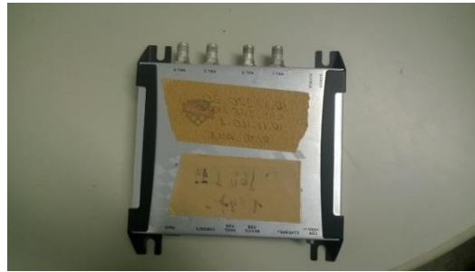
Figura 3. Leitor RDIF Impinj modelo Speedway Revolution R420.
