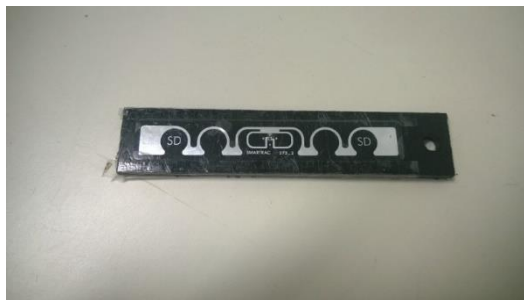
Figura 5. Etiqueta RFID (TAG) Impinj modelo Monza 4
