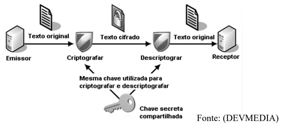
Figura 2 - Processo de criptografia simétrica.
