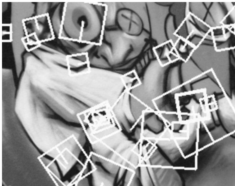
Figura 3.12 – Criação de janelas para a descrição dos pontos de interesse. Fonte: (BAY et al, 2006).
