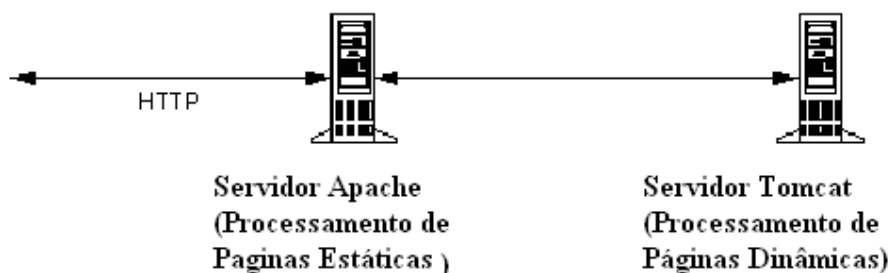
Figura 9: Balanceamento de carga por tipo de processamento de página.
