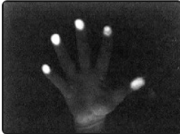
Figura 22- Detecção da interação por monitoramento de imagem em infravermelho (NUIGROUP, 2010).
