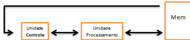
Figura 2. Exemplo de Arquitetura SISD - Von Neumann. (PITANGA, 2008).
