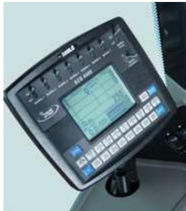
Figura 25 – Controlador CASE SCS4400
