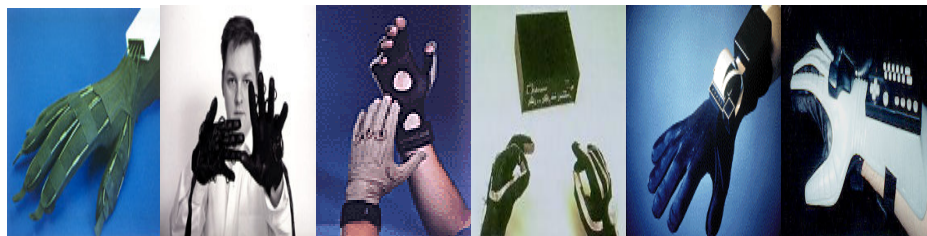
FIGURA 2: Luva de Dados (Equipamentos, 2006).
