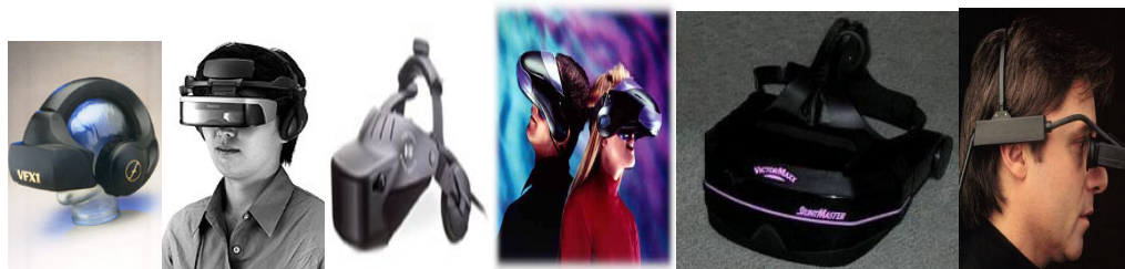
FIGURA 1: Vídeo Capacete – HMD (Equipamentos, 2006)
